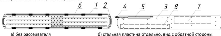
Рисунок 2 – Конструкция внутренней части светильника:
